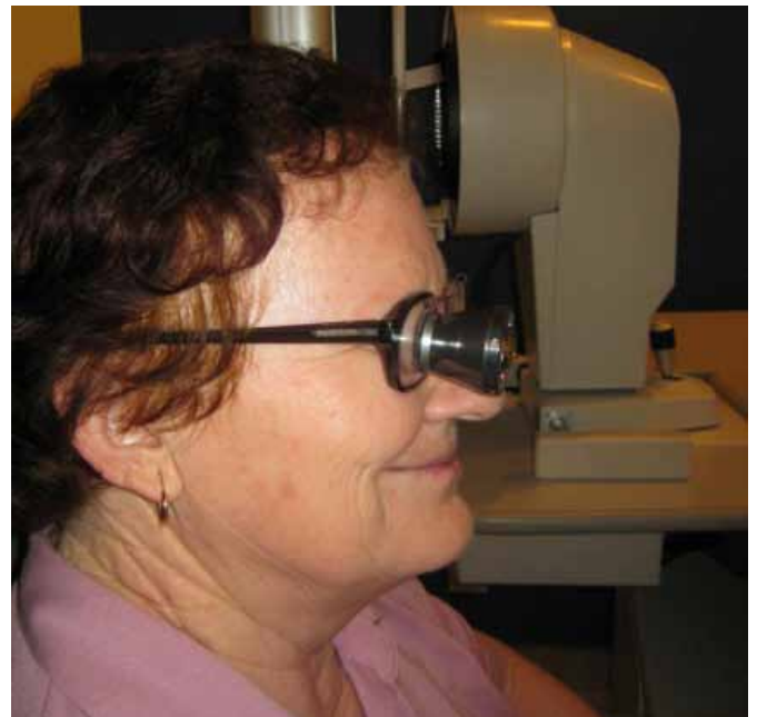
Slika 5: Teleskopska lupa montirana na ram naočara
